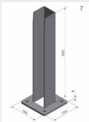
**Bodenplatte 150 x 150 mm, für Pfosten 80 x 80 mm, zum Aufdübeln, lose** **7**
