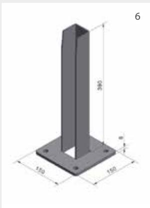
**Bodenplatte 150 x 150 mm, für Pfosten 60 x 60 mm, zum Aufdübeln, lose** **6**
