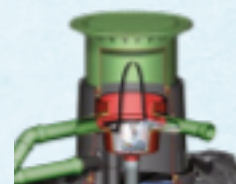
Zwischenstück »600/L 400« Erhöhen der Erdüberdeckung um 300 mm
